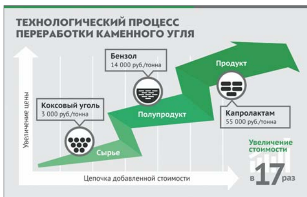
Рис. 3. Технологический процесс переработки каменного угля
