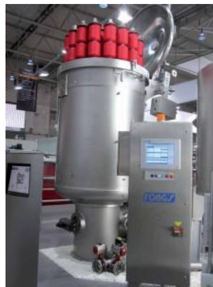
Установка поверхностного крашения нитей, а также нанесения пропиток (огнеупорных водоотталкивающих)
